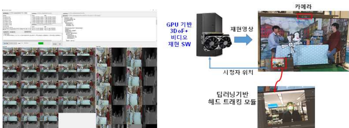
그림. ETRI의 MIV기반 3DoF+ 비디오 생성(좌) 및 재현 실험시제품(우)
